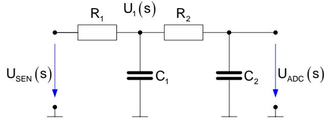
Die Übertragungsfunktion des Filters wird in zwei Schritten berechnet. Im ersten Schritt wird die Übertragungsfunktion des rechten Schaltungsteils bestimmt.
